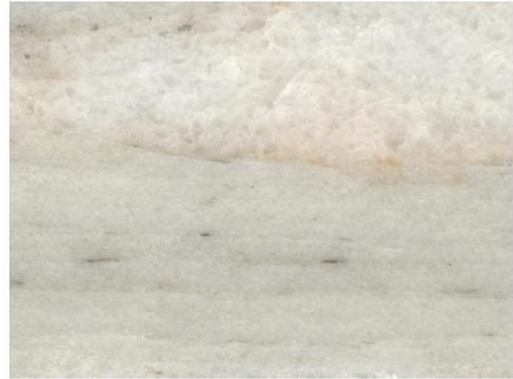
Abb 3-02: Heller Silberquarzit, nur aus Quarz und Hellglimmern bestehend; in der oberen Bildhälfte ist eine grobkörnigere Partie erkennbar (AS 08.02.10-2, Bildbreite 2,5 cm).
