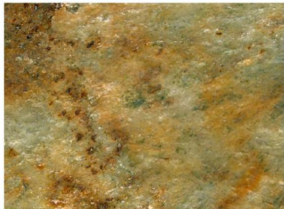
Abb 3-06: Stark verwitterte Partie von hell-rötlichem Silberquarzit mit ehemals hohem Pyritgehalt (AS 08.02.10-6, Bildbreite 4 cm).
