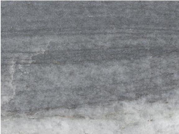
Abb. 3-07: Dunkler Silberquarzit, bestehend aus Quarz, Chlorit und Muskovit (AS 08.02.10-7, Bildbreite 2 cm).
