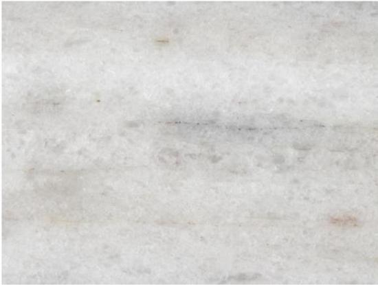
Abb 3-01: Heller Silberquarzit, der lediglich aus Quarz und Hellglimmern besteht (AS 08.02.10-1, Bildbreite 2 cm).
