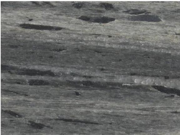
Abb. 3-09: Glimmerlage im dunklen Silberquarzit mit großen, schwarzen Hornblendekristallen (AS 08.02.10-9, Bildbreite 1,5 cm).
